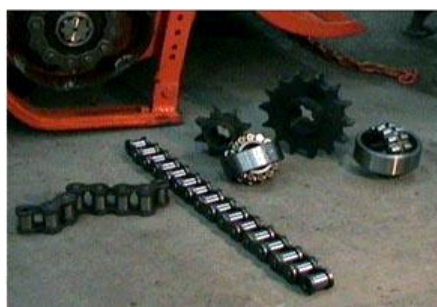
3 Detalle Rodamientos, piñones y cadena reforzada 1 1/2 "
