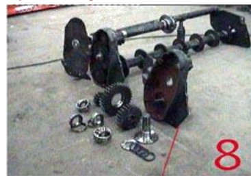
Caja carter lateral de Fundición Nodular
